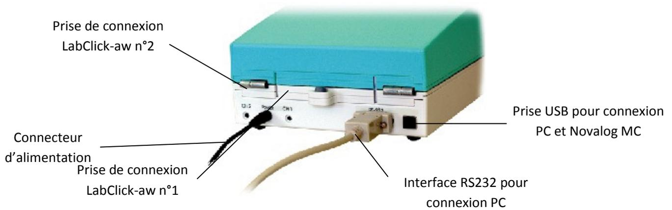
Les connectiques sont situées à l'arrière de l'appareil.
