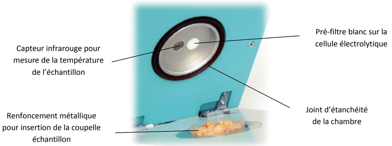
La partie intérieure de la chambre de mesure est équipée de toutes les caractéristiques capteurs.
