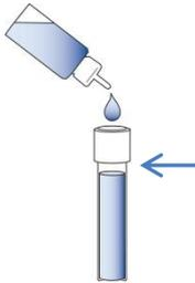
**4.** Fermer le tube avec le bouchon puis homogénéiser manuellement et vigoureusement pendant **1 minute**.
