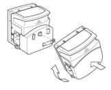
3 Assemblez les deux têtes de pompe en verrouillant la tête de pompe d'origine sur l'extension de tête de pompe. Lorsque vous mettez la tête de pompe d'origine en place, assurez-vous que le mécanisme de verrouillage s'enclenche avec un déclic audible. Important : les galets des deux têtes de pompe doivent être hors phase afin d'éviter une contrainte excessive sur le moteur (limites du couple) et d'obtenir une réduction de la pulsation de flux.
