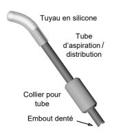
Les tubes d'aspiration / distribution fournis avec la pompe DOSE IT facilitent le processus de dosage et sont installés aux extrémités du tuyau. Une extrémité du tube d'aspiration est dentée afin de garantir un écoulement libre du liquide entrant dans le tuyau. Assurez-vous de ne pas insérer l'embout denté du tube d'aspiration dans le tuyau en silicone.
