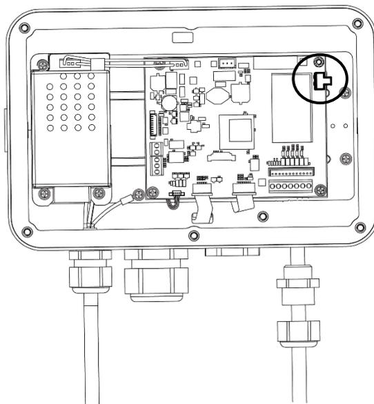
Figure 5-2 Emplacement du commutateur de sécurité (S1), i-DT33XW
