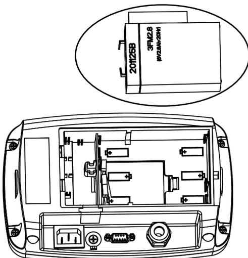
3. Poussez légèrement l'extrémité de la protection de charge (entouré) dans le sens de la flèche et retirez-le.
