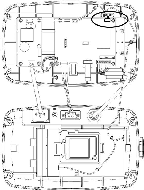
Figure 5-1 Emplacement du commutateur de sécurité (S1), i-DT33P
