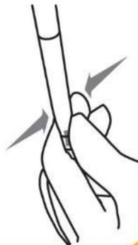
En pinçant la partie basse du dispositif, écraser la pastille dans le liquide jusqu'à ce que les particules de la pastille en suspension aient une apparence homogène.
