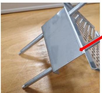
Visser les tiges dans les écrous situés à l'arrière du MICROBIO :
