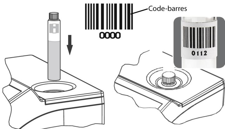
A l'insertion du tube de test, **HI 83224** lit automatiquement le code-barres marqué sur le tube et configure en toute autonomie la méthode et la plage de mesure adéquates à l'échantillon.
