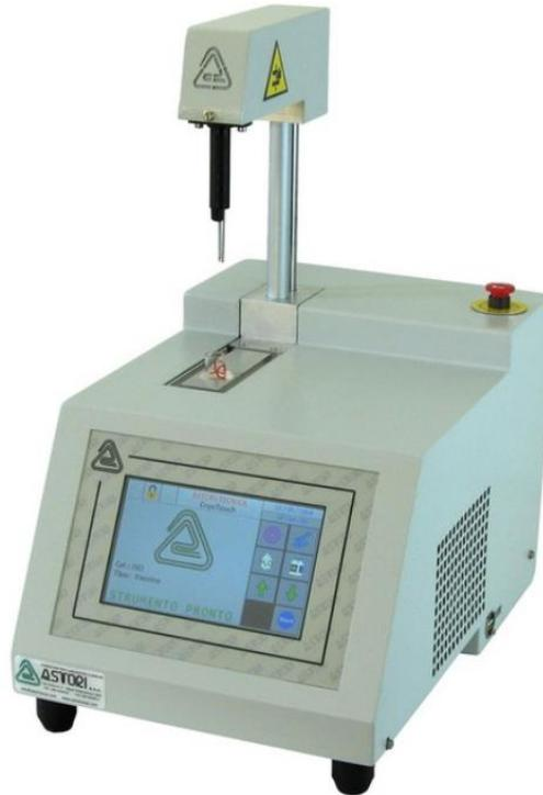
Le CryoTouch est un appareil automatique à échantillon pour la détermination rapide de la variation du point cryoscopique du lait causée par l'ajout d'eau, en totale conformité avec la norme de référence internationale **IDF-ISO 5764:2009**.
