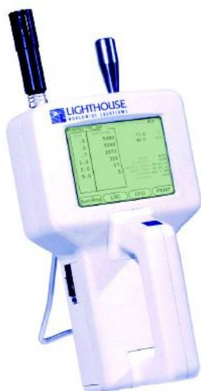
Le Compteur de particules HH3016 IAQ est un compteur petit et portable, particulièrement conçu pour mesurer simultanément les particules en nombre et en masse  $\mu\text{g}/\text{m}^3$ .
