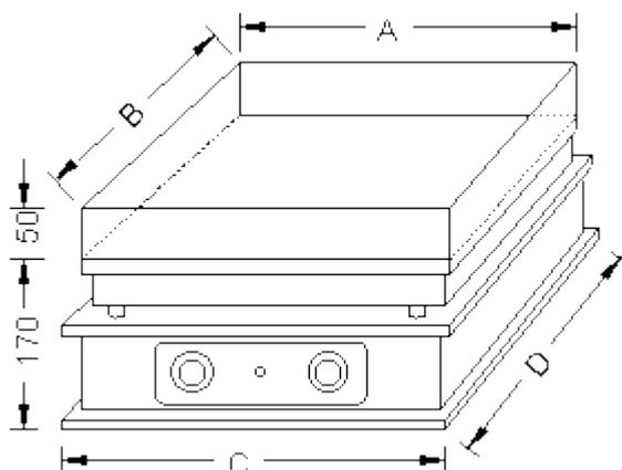
Plaque en alliage d'aluminium, boîtier en acier inoxydable avec contrôle de température réglable.
