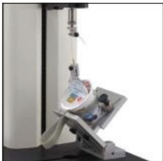
Mesure la force d'adhérence nécessaire pour retirer le couvercle d'un container fermé hermétiquement à des angles de 0°, 45° et 90°.
