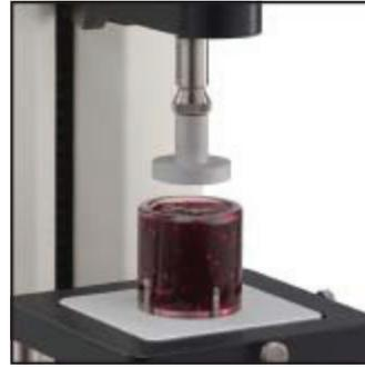
Cellule d'extrusion double pour l'extrusion vers l'avant ou l'arrière de purées de fruits, puddings, yaourts ou des produits similaires. Table de base de montage requise.
