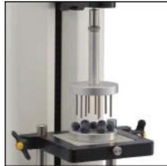
Composé de 9 sondes de 3 mm et d'une plaque de base conçue pour le maintien de 9 petits échantillons de forme irrégulière. Table de base requise.
