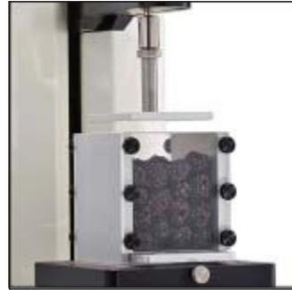
Pour compression en vrac pour déterminer la dureté et le croustillant de céréales, de légumes ou de fruits. Table de base de montage requise.
