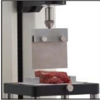
Pour essai de cisaillement : viande, poisson, saucisse, etc. TA-SBA-WB-3 en option pour des lames de 3 mm. Table de base de montage requise. TA-SBA-WB-1 **F**
