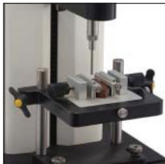
Pour le maintien de petits échantillons lors des tests de perforation. Recommandé pour les bonbons, les gommes, etc. Table de base rotative requise.
