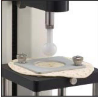
Pour maintenir une feuille de pâte crue ou du pain plat et mesurer le point de rupture d'un échantillon étiré. Sonde à bille non incluse. Table de base de montage requise.
