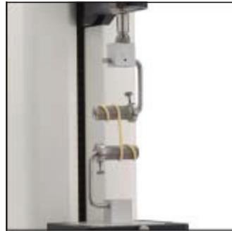
Pour évaluer la qualité des nouilles en s'étirant avec le test de tension. Table de base de montage requise.
