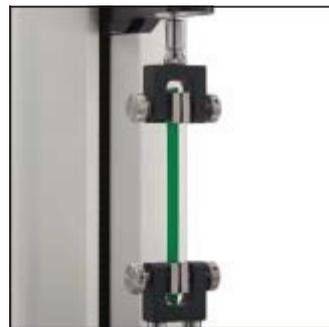
Dispositif à poignée double pour des essais de traction des films fins ou l'intégrité des scellés pour l'emballage.
