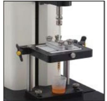
Pour mesurer la force nécessaire pour pousser ou tirer le piston d'une seringue. Test important pour tous les types de seringues. Table de base requise.
