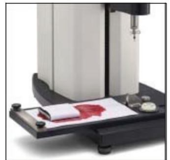
Ce système de friction coulissant mesure le coefficient de friction de matériaux d'emballage selon ASTM D1894.
