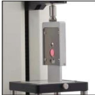
Pour mesurer la force de cisaillement pour couper un comprimé de deux parties ou une capsule à l'aide d'une lame de guillotine. Table de base de montage requise.
