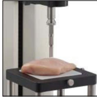
Utilisé pour les tests de découpe de la viande, du poisson, de la volaille ou des produits similaires. Table d'essai ou plateau tournant recommandé.
