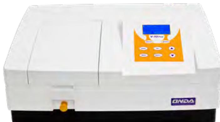
**V-10 Plus** è lo spettrofotometro Visibile per le applicazioni colorimetriche e le misurazioni di routine, molto utile per la fotometria di base, conta batterica **OD600** e analisi del colore del vino. Design solido e componenti di alta qualità assicurano prestazioni eccellenti.
