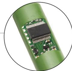
Les nouvelles électrodes conçues pour **edge** sont aussi innovantes que l'instrument lui-même. Munies d'une puce électronique, elles ont en mémoire type de la sonde, données d'étalonnage et numéro de série. Ces informations sont automatiquement transférées sur l'instrument dès leur connexion.
