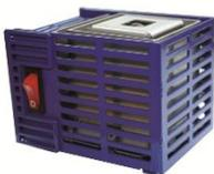
Le bec électrique TECHNI+ est un appareil de chauffe pouvant se substituer au Bec Bunsen.
