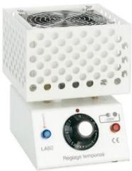
Le bec électrique de laboratoire LAB 2 ou LAB 3 est un appareil chauffant des tubes à essais ou autres récipients à fond plat, permettant de réaliser diverses expériences de chimie faites auparavant avec le Bec Bunsen. Il génère un flux d'air chaud opérationnel ascendant qui varie entre 650 et 750 °C selon le modèle. Il est parfaitement stable et peu encombrant (L170 mm x P130 mm x H195 mm). Il produit une flamme à l'aide d'une pastille posée au centre du bec (procédé Ecoflam).
