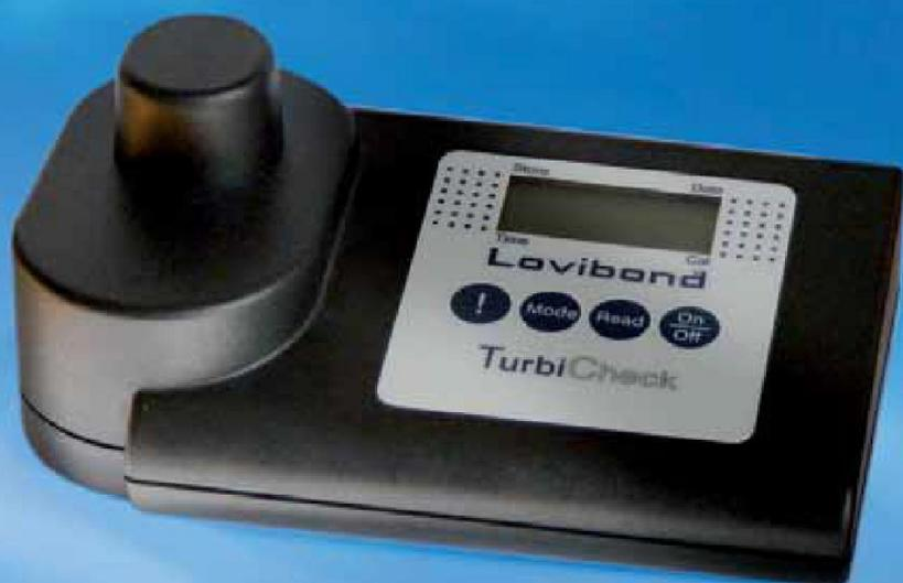
Turbidimètre compact TurbiCheck pour les analyses rapides et exactes sur le terrain. Comme le prévoit la norme EN ISO 7027, il mesure la lumière diffusée dans un angle à 90°.
