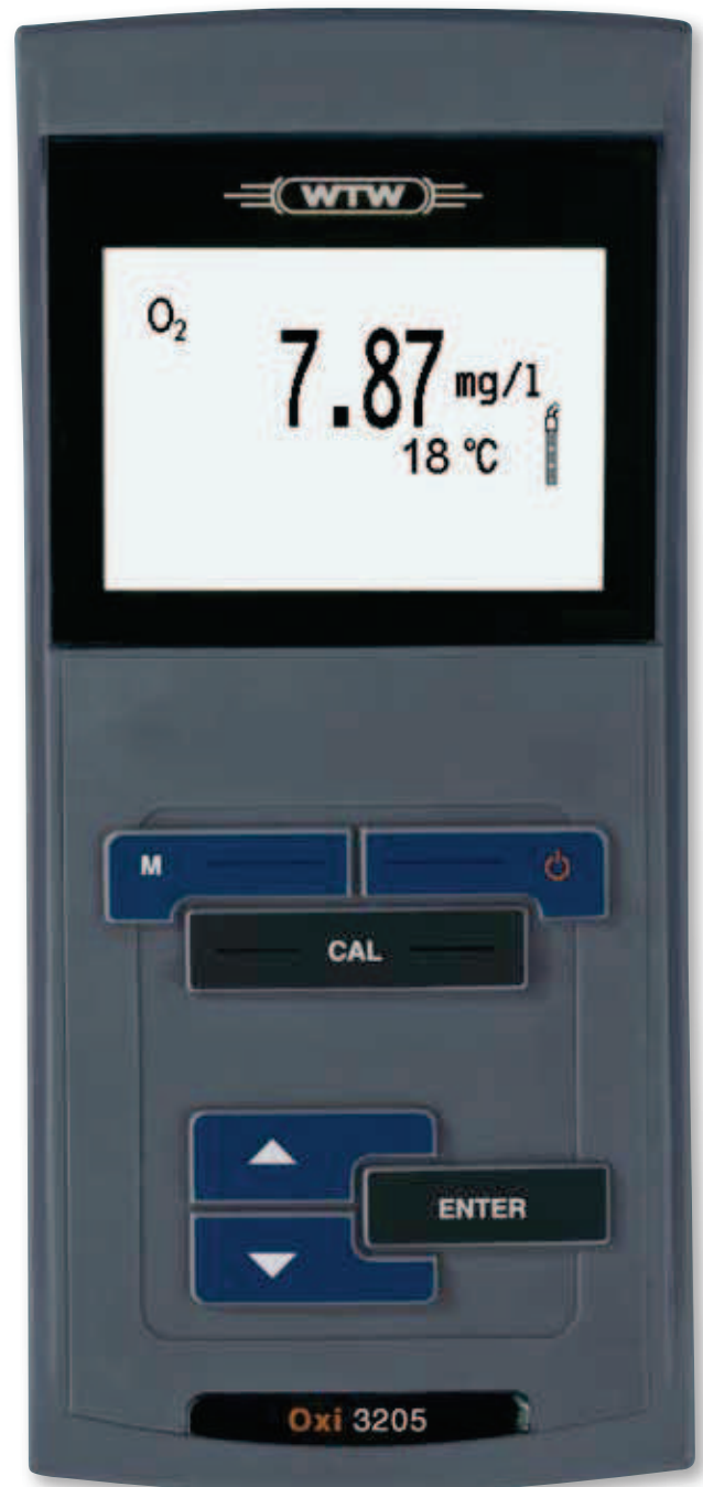
Mesure de l'oxygène avec ProfiLine Oxi 3205 et DurOx® avec tête de protection dans la pisciculture
