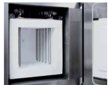
Isolation à fibre céramique
