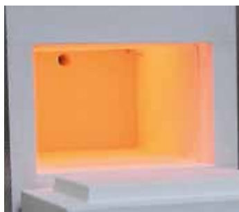
Chauffage du moufle par 4 côtés
