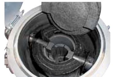
Module de chauffage au graphite
