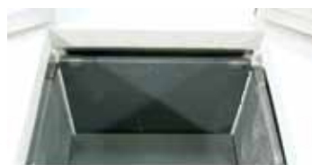
Chambre du four S 73/HS protégée par des barres SIC
