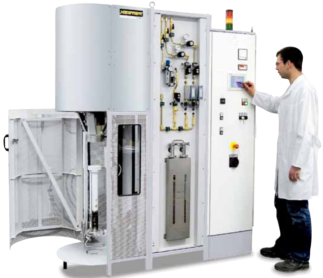
RHTV 120/480/16 LB dans une exécution réalisée sur spécifications du client avec, sur un côté, un tube de travail fermé, options gaz protecteur et vide ainsi qu'un entraînement à broche pour la table élévatrice
