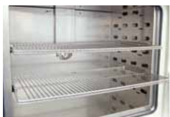
Grilles mobiles pour le chargement de l'étuve sur différents niveaux
