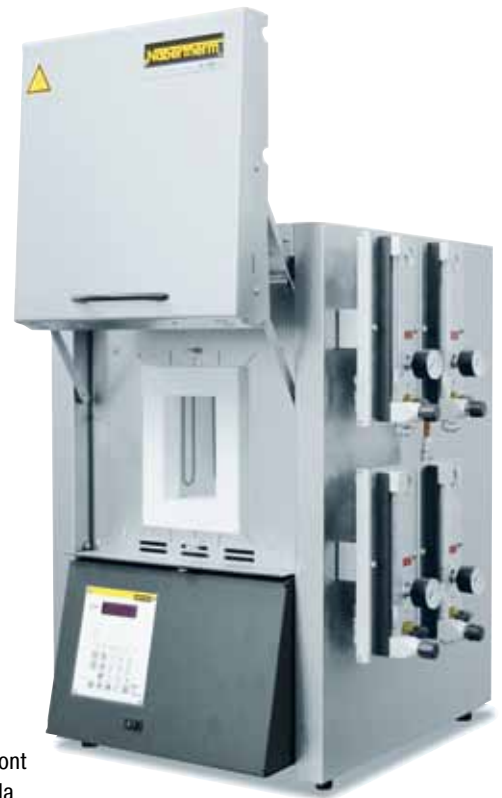
LHT 02/18 avec système de mise sous gaz à quatre gaz
