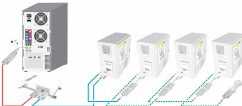
Extension pour raccordement de 16 fours maximum
