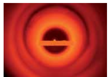
Passage sous hydrogène pour le frittage dans un four tubulaire de la série RHTH
