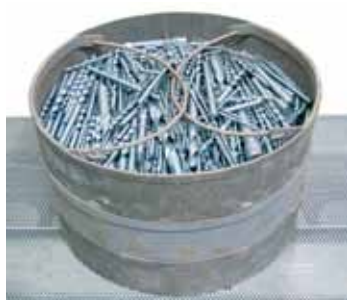
Bleuissement de forets à la vapeur dans un four de la série NRA
