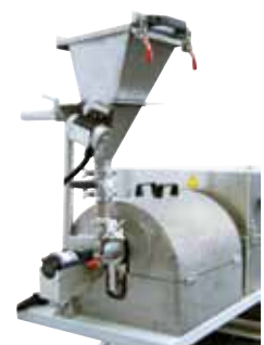
Vibrateur sur la trémie de remplissage pour améliorer l'alimentation des poudres
