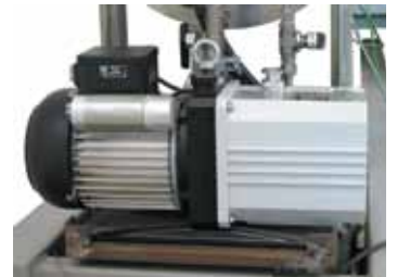
Pompe à vide pour la purge à froid du moufle
