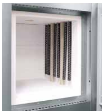
Barres SiC suspendues à la verticale
