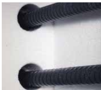
Chambre du four avec matériau fibreux de grande qualité et barres chauffantes SiC des deux côtés
