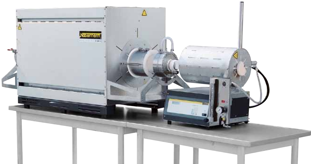
RHTH 120/600/16 avec four RT 50-250/11 monté en amont pour le préchauffage du gaz de process
