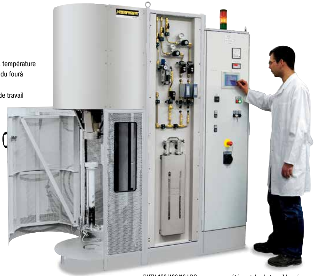
RHTV 120/480/16 LBS avec, sur un côté, un tube de travail fermé, options gaz protecteur et vide ainsi qu'un entraînement à broche pour la table élévatrice
