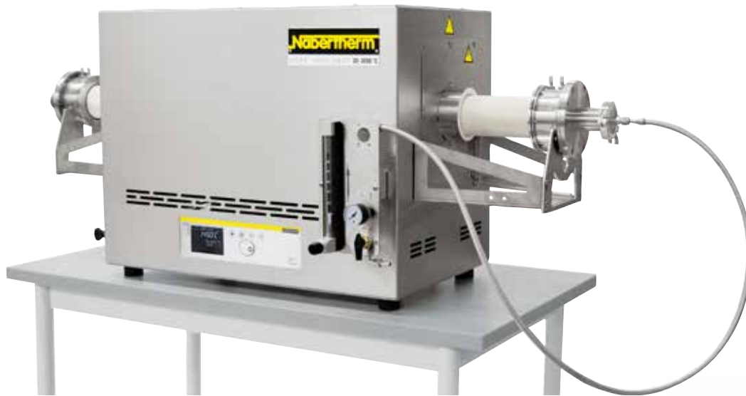
RHTC 80-450/15 avec système d'alimentation en gaz manuel
