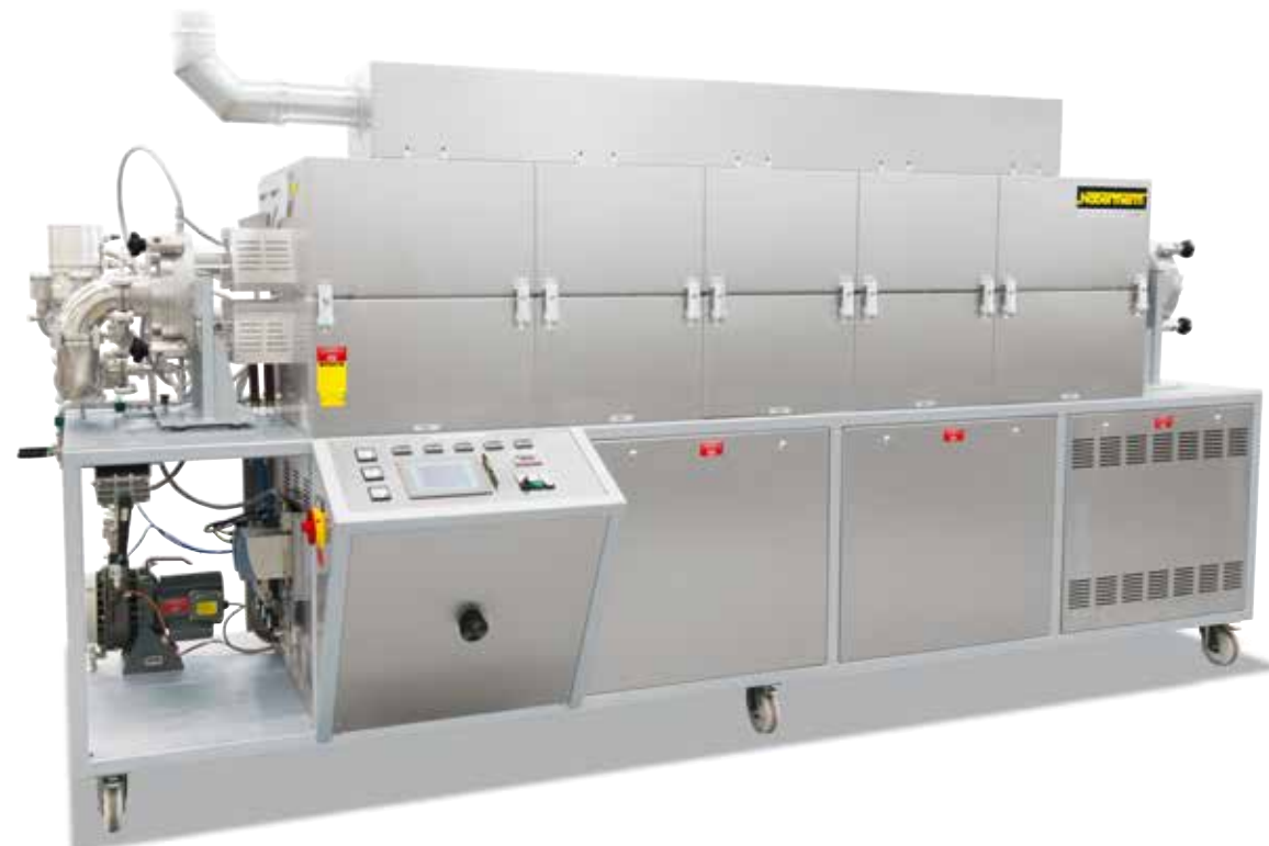
RS 250/2500/11S avec 5 zones régulées, pour le recuit de fil sous vide ou sous gaz protecteur, incluant hotte d'extraction et refroidissement forcé
