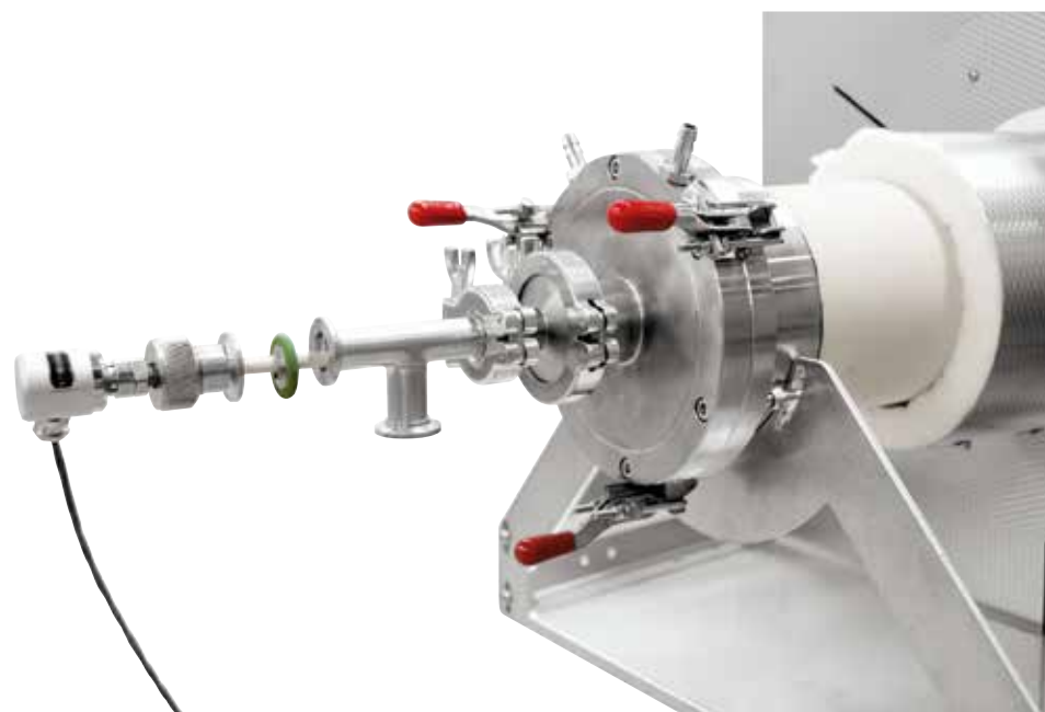
Thermocouple pour régulation de la charge dans le four RHTH 120/600/18
