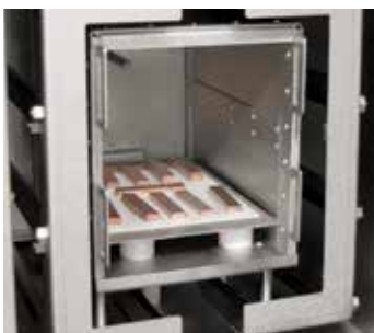
Traitement thermique de barres de cuivre sous hydrogène dans VHT 8/16-MO
