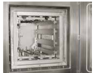
Élément chauffant en tungstène
