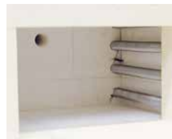
Intérieur du four avec isolation en briques réfractaires légères de qualité supérieure
