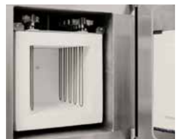
Isolation à fibre céramique
