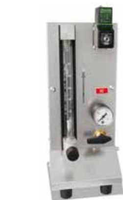
Système d'alimentation en gaz pour gaz protecteurs ou réactifs non combustibles avec robinet de sectionnement et débitmètre avec vanne de régulation prêt à être raccordé à la tubulure
