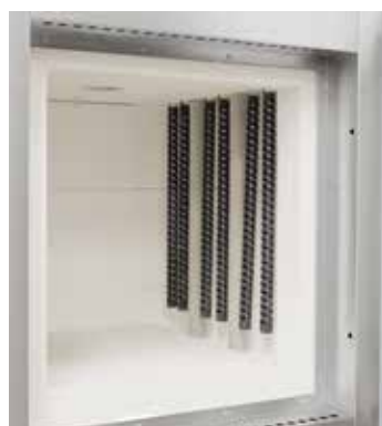
Barres SiC suspendues à la verticale
