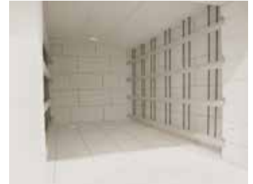
Grille protectrice devant les éléments chauffants en guise de protection contre les dégradations mécaniques
