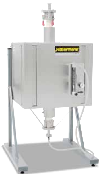
Four tubulaire vertical RHTV 50/150/17 avec support et ensemble d'alimentation en gaz 2 en option
