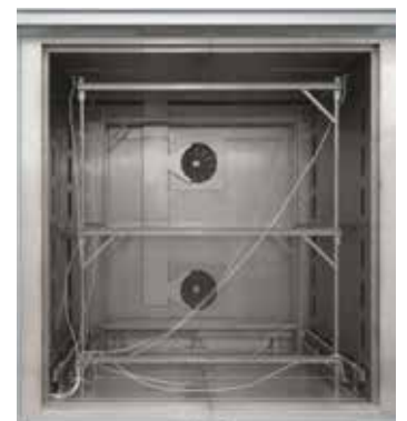
Cadre de cartographie adapté pour four à chambre à circulation d'air N 7920/45 HAS
