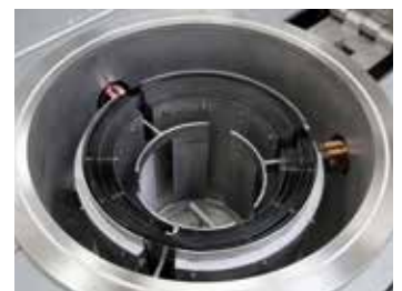
Moufle cylindrique avec système de chauffage au wolfram
