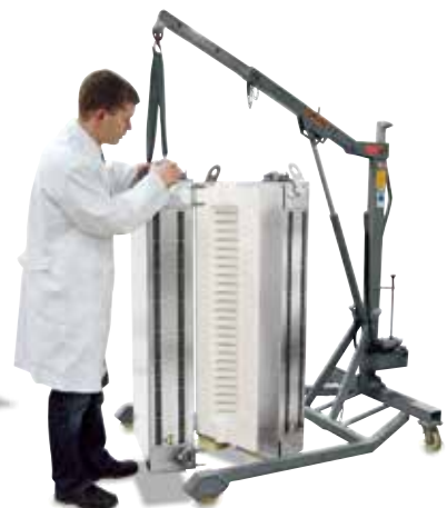
RS120/1000/11S en version séparée. Les deux demi fours sont fabriqués à l'identique et seront intégrés à un système de chauffage au gaz existant, dans un concept de gain de place
