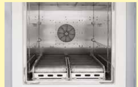
Plateau à rouleaux dans la chambre du four
