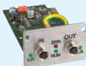
LRZ 922 Module EtherCAT avec raccord M8
