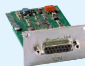
LRZ 915 Module de contact avec 3 entrées et 3 sorties
