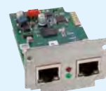
LRZ 923 Module EtherCAT avec raccord RJ45
