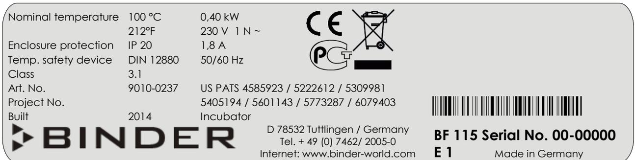
Figure 1: Plaque signalétique (exemple BF 115 standard)
