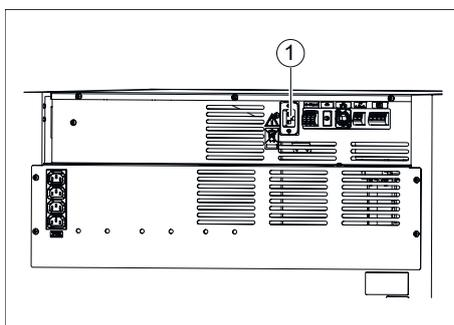
Fig. 19 : Raccord alimentation en courant
