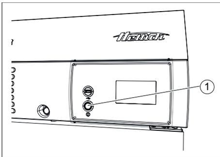
Fig. 22 : Interrupteur de l'appareil
