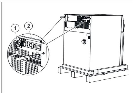
Fig. 15 : Monter la barre métallique
