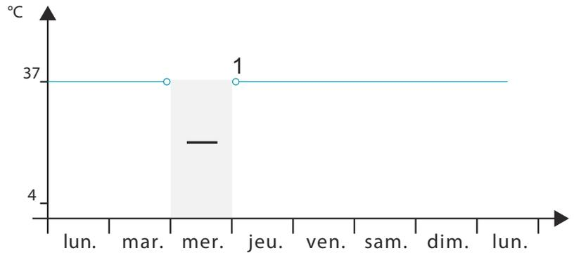
Fig. 216 : Diagramme « L'incubateur sera toujours nettoyé le mercredi conformément à la routine de laboratoire (SOP) (Mode arrêt) »
