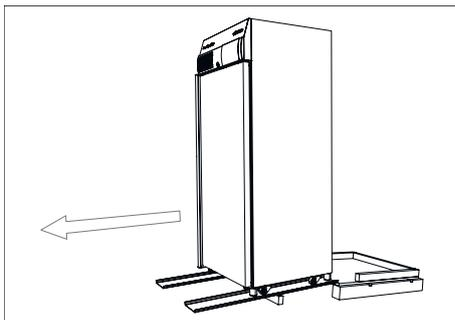
**Fig. 13 : Faites rouler l'incubateur sur les rails métalliques pour le descendre**
