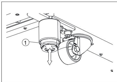
Fig. 18 : Mise à niveau de l'incubateur
