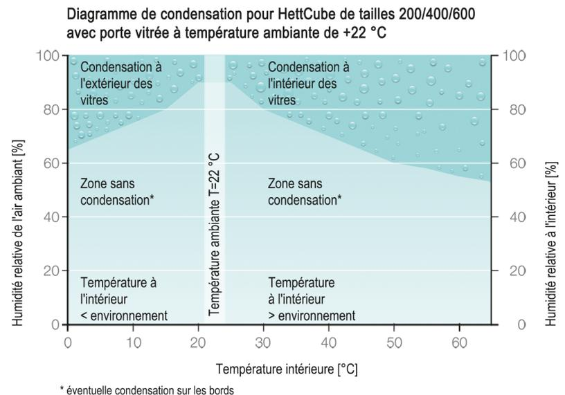
Fig. 7 : Diagramme de condensation
