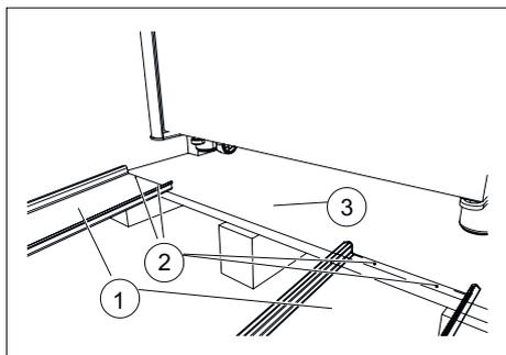
Fig. 10 : Fixer les rails métalliques
