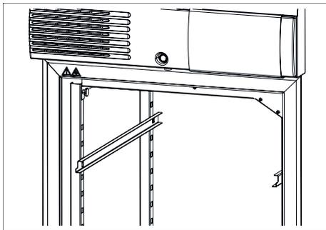
*Fig. 196 : Retirer rails d'appui*
