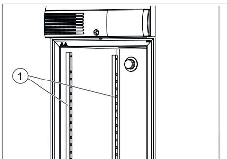
Fig. 199 : Rails d'arrêt
