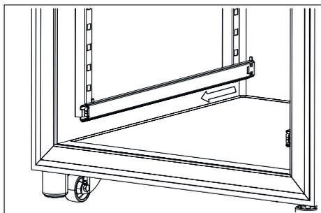
*Fig. 41 : Retirer le rail télescopique du rail d'arrêt arrière*
