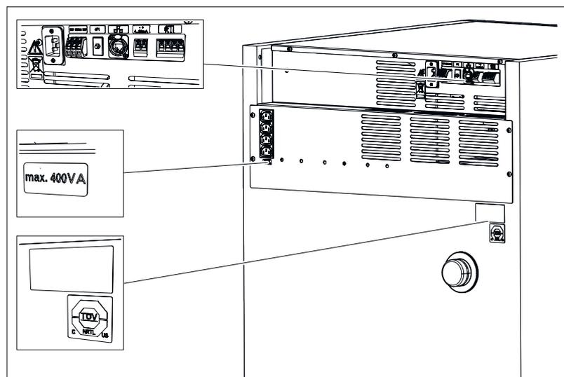
*Fig. 1 : Avis placés à l'arrière de l'incubateur*
