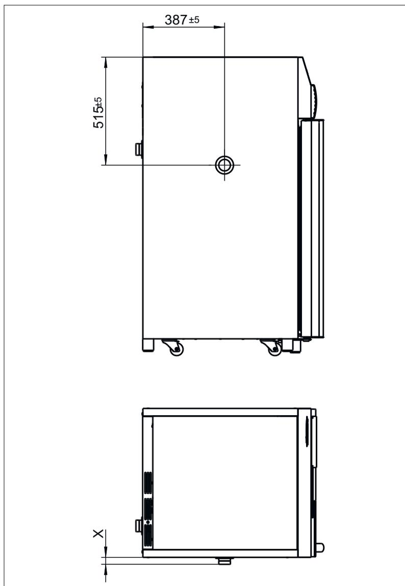
*Fig. 206 : Dimensions « Passage de câble sur le côté »*
