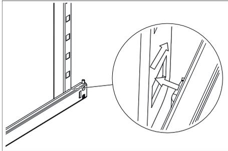
*Fig. 36 : Emboîter le rail télescopique à l'arrière*
