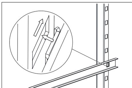
Fig. 33 : Emboîter le rail d'appui à l'arrière
