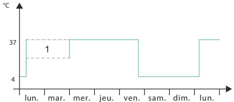
*Fig. 211 : Baisse de température pendant le week-end avec démarrage différé*
