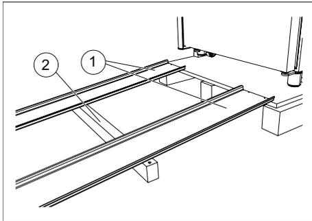
**Fig. 11 : Poutre sous les rails métalliques**
