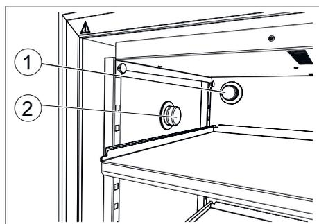
Fig. 6 : Passage de câble sur le côté gauche de l'incubateur (en option)
