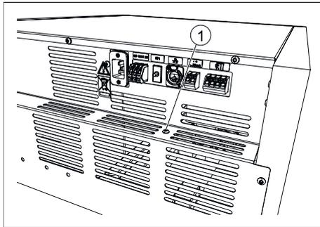
Fig. 44 : Vis blocage annexe du champ de commande
