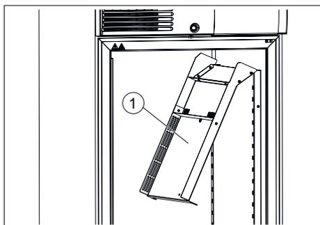
Fig. 198 : Tôle supérieure du conduit d'air
