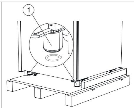
**Fig. 12 : Visser les éléments de mise à niveau**
