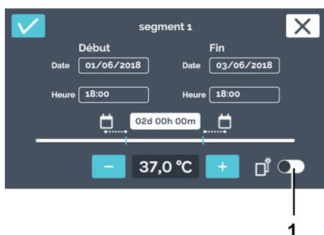
Fig. 103 : Activer le contrôle de contact électrique
