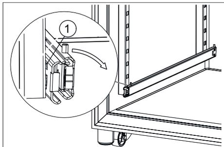
*Fig. 39 : Tourner l'avant du rail télescopique*
